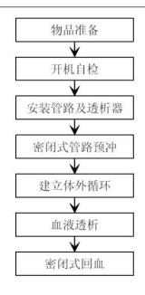
图 2-4 血液透析机及透析流程示意图
