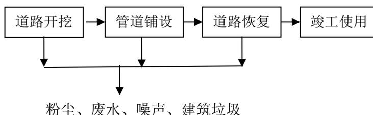
图 3.3-1 施工期管路铺设工艺流程及产污节点图
